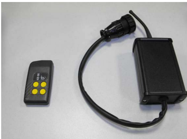
Изобр. 2 Блока дистанционного запуска с помощью радиосвязи
