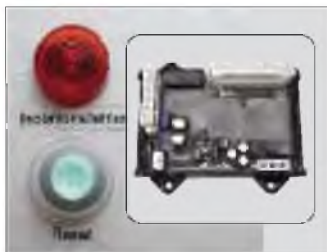
Контроль изоляции Потребители автоматически отключаются, если изолирующее сопротивление достигает критического значения.
