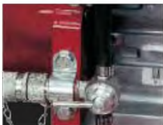
3-ходовой топливный кран Для непосредственного соединения с заправочной системой.
